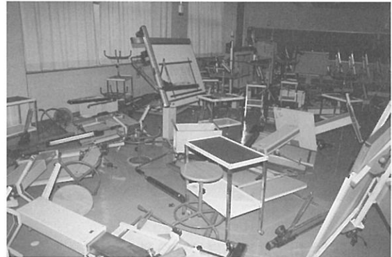
東日本大震災のドラフター転倒
