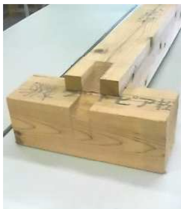
図23 桁と小屋梁の接合部 (かぶと蟻)
