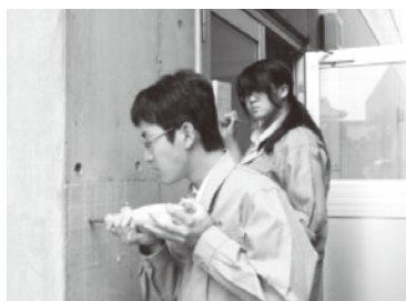
シュミットハンマーによる非破壊実験
