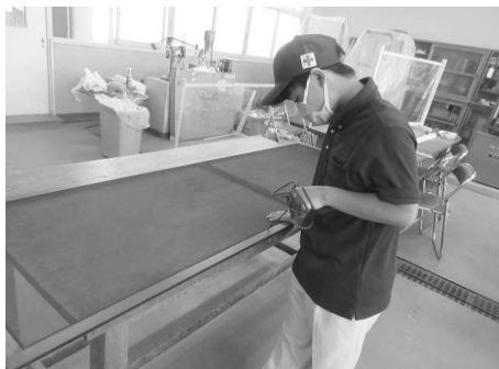
網戸の張り替え作業
