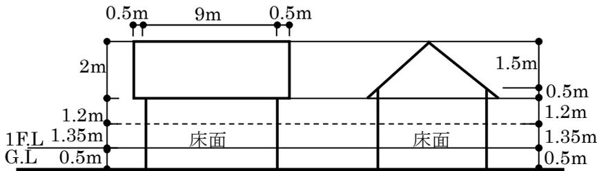
・張り間方向・けた行方向にそれぞれの必要軸組長さは、①地震力に対する各階の検討（床面積をベースに考える）②風圧力に対する各階の検討（見付面積をベースに考える）のそれぞれから算出し、その値の大きいものを必要長さとする。
