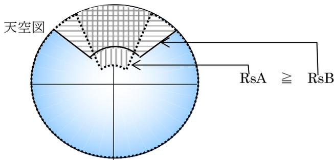
—— 斜線規制による適合建築物の天空図 [RsB]
